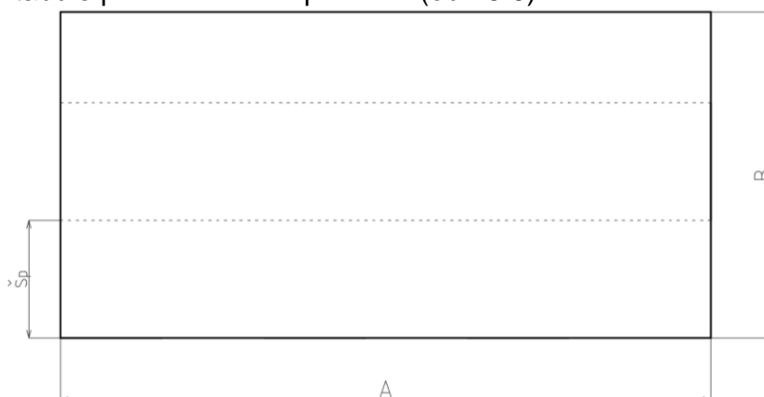
Obr. 5.6 Rozloženie pásov na plechu – varianta A.
