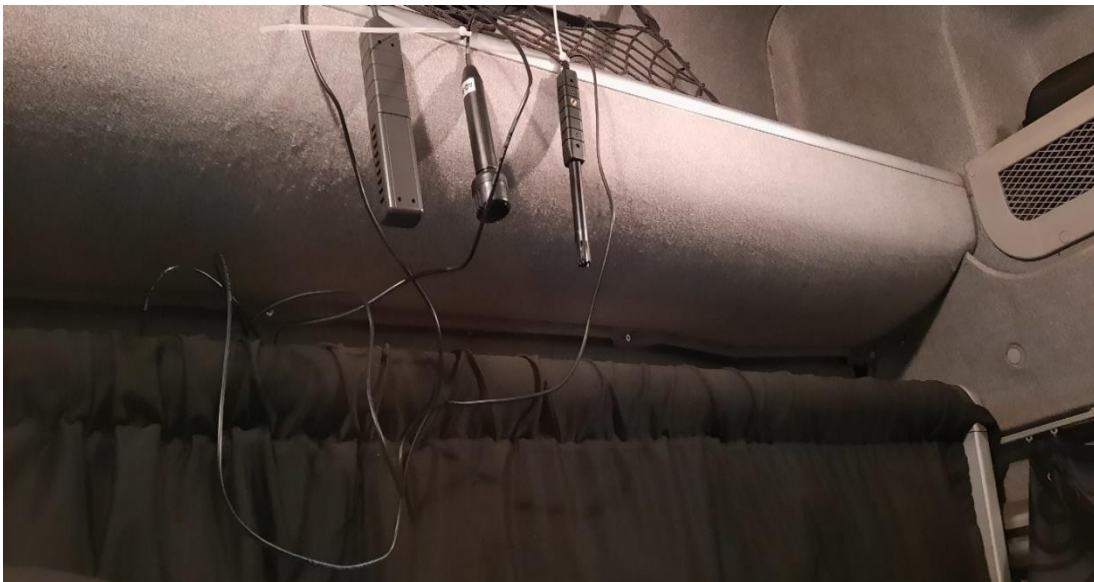
Obr. 8 Umístění sond v kabině nákladního vozu
