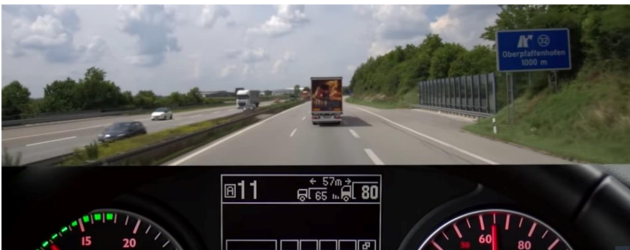
Obr. 3 Asistenční systém MAN Cruise Assist (Asistent pro dálkovou dopravu MAN Cruise assist, 2020)
