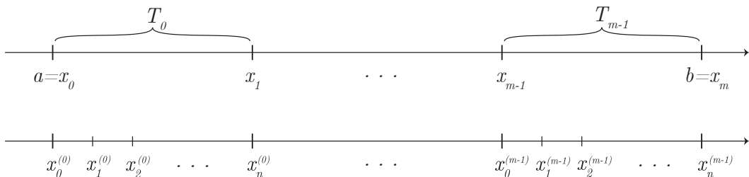
Obrázek 8: Rozdělení intervalu \langle a, b \rangle při použití složených formulí.
