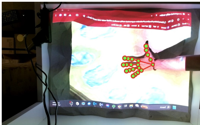
Obrázok 4.9: Úspešné rozpoznávanie pri projekcii na ruku.
