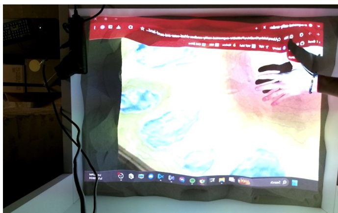
Obrázok 4.10: Neúspešné rozpoznávanie pri projekcii na ruku.
