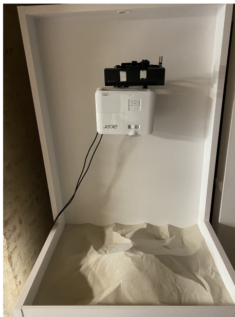
Obrázek 2.1: Fyzické riešenie AR SandBoxu.
