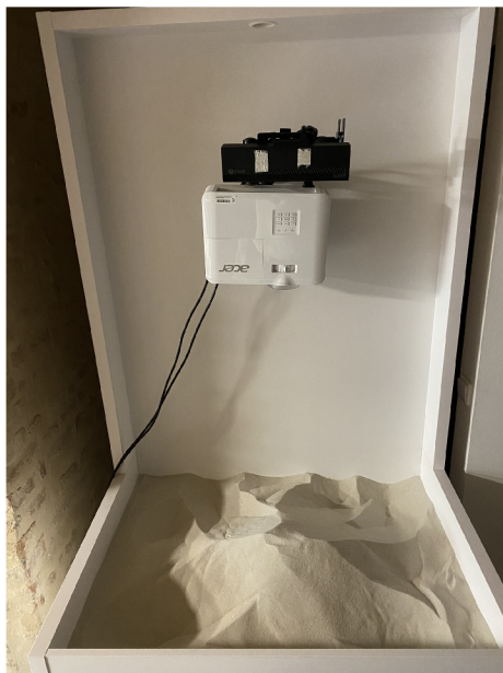
Obrázek 2.1: Fyzické riešenie AR SandBoxu.
