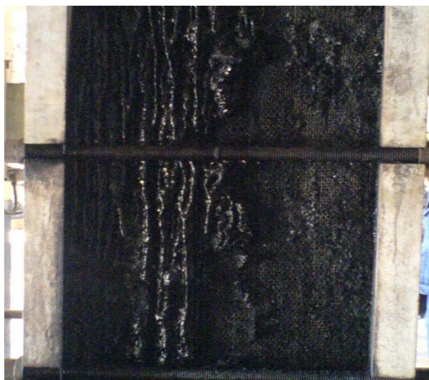
Obr. 2 Zanesený deskový výměník tepla [23]
