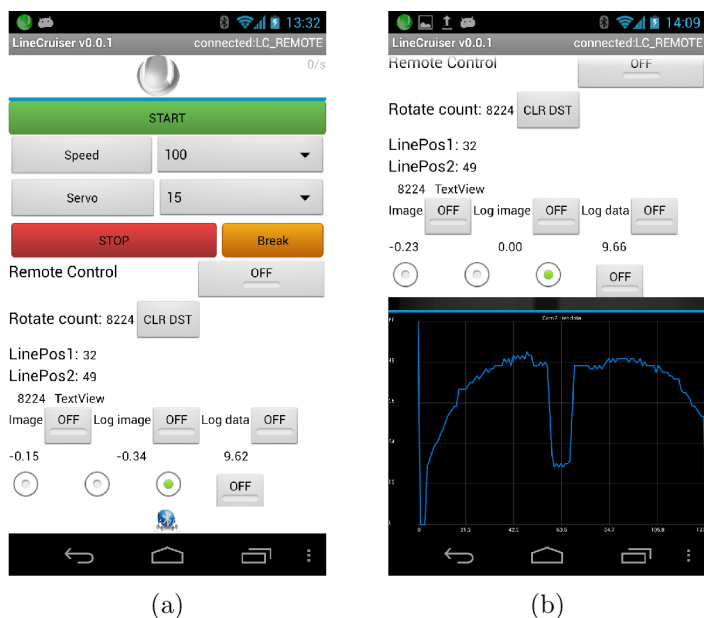
Obr. 4.4: Aplikácia LineCruiser: a) základné nastavenie vozidla a zobrazenie potrebných dát, b) graf a šedotónový obraz z kamery prenášaný počas jazdy vozidla
