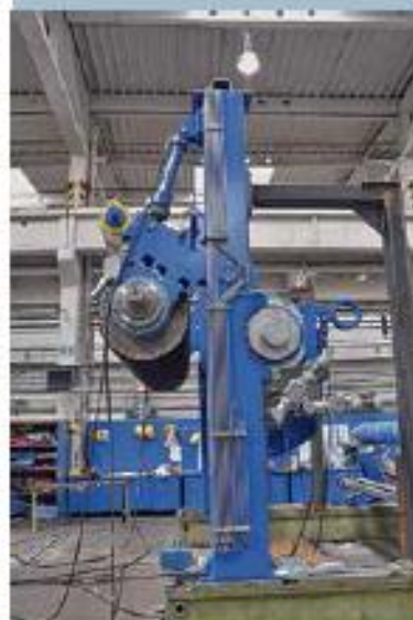
Рис. 9. Контрольный монтаж оборудования для прессовой части БДМ, заказчик из России.
