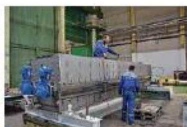
Рис. 8. Комплектация нового напорного ящика шириной 6800 мм, заказчик из Чешской Республики.
