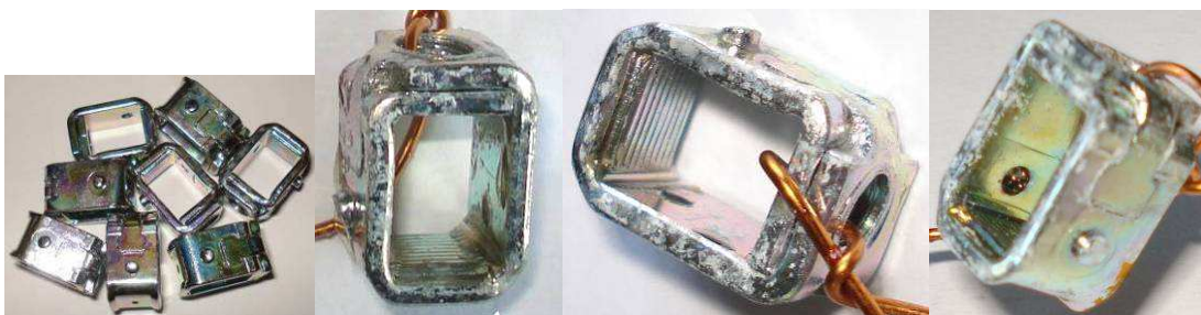
Obr. 6-13 Průběh vzniku koroze na Zn6 ve vlhkostní komoře
