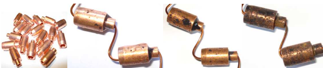
Obr. 6-6 Průběh vzniku koroze na Cu6 ve vlhkostní komoře.
