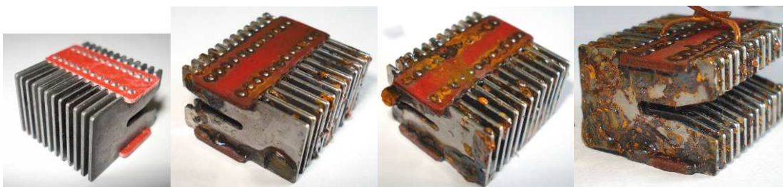
Obr. 6-4 Průběh vzniku koroze bez PÚ ve vlhkostní komoře.
