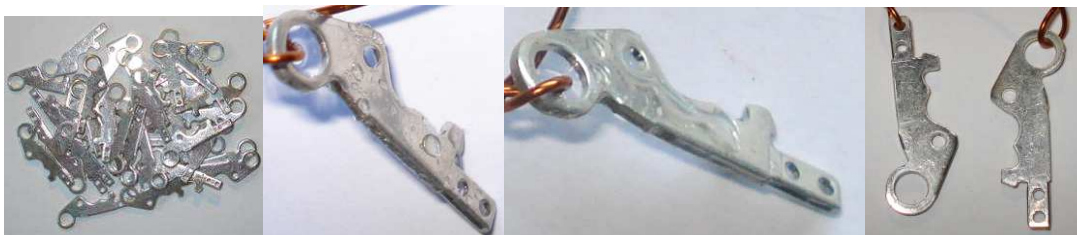
Obr. 6-20 Průběh vzniku koroze na Cu3Sn6 ve vlhkostní komoře
