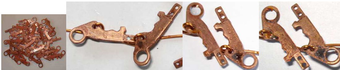
Obr. 6-18 Průběh vzniku koroze na Cu3 ve vlhkostní komoře
