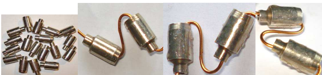
Obr. 6-8 Průběh vzniku koroze na Sn6 ve vlhkostní komoře.
