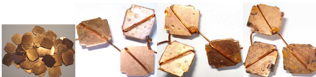
Obr. 6-27 Průběh vzniku koroze na Cu 6 ve vlhkostní komoře
