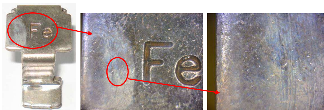
Obr. 6-34 Snímek dílce pas přívodní horní s Cu2Sn4 vrstvou po zkoušce korozní odolnosti
