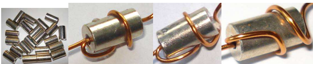
Obr. 6-11 Průběh vzniku koroze na Cu1Sn6 ve vlhkostní komoře
