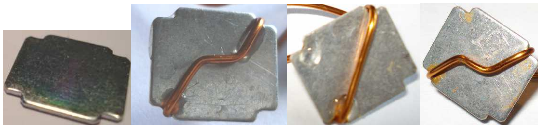
Obr. 6-29 Průběh vzniku koroze na Cu 1 Sn 6 ve vlhkostní komoře
