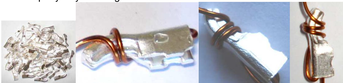
Obr. 6-16 Průběh vzniku koroze na Ag3 ve vlhkostní komoře
