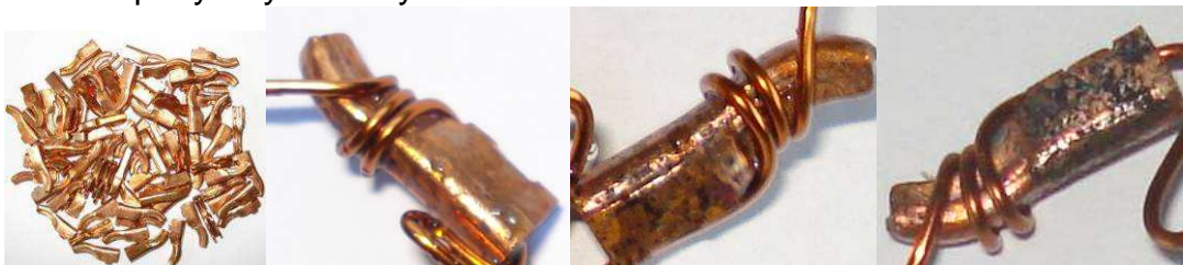
Obr. 6-15 Průběh vzniku koroze mědi ve vlhkostní komoře
