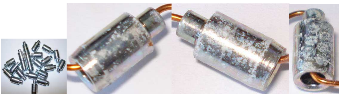
Obr. 6-7 Průběh vzniku koroze na Zn6 ve vlhkostní komoře.
