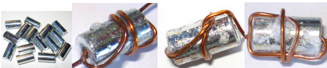
Obr. 6-10 Průběh vzniku koroze na Zn6 ve vlhkostní komoře
