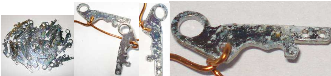
Obr. 6-19 Průběh vzniku koroze na Zn6 ve vlhkostní komoře
