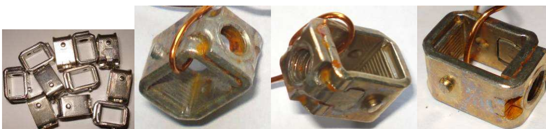
Obr. 6-14 Průběh vzniku koroze na Cu3Sn6 ve vlhkostní komoře
