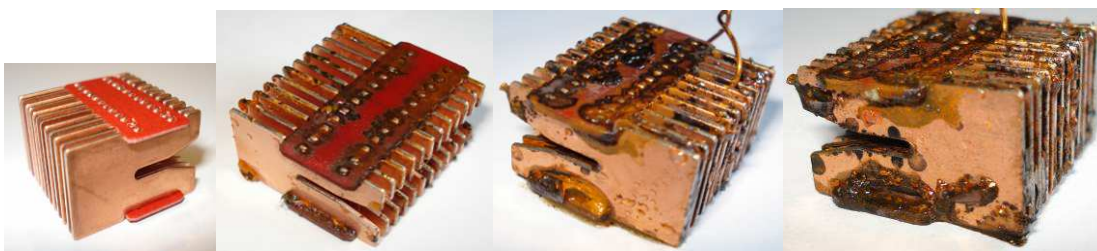
Obr. 6-3 Průběh vzniku koroze na Cu 2 ve vlhkostní komoře.
