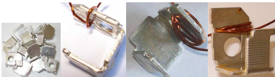
Obr. 6-26 Průběh vzniku koroze na Cu 2 Sn 4 ve vlhkostní komoře
