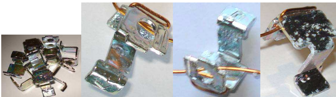
Obr. 6-22 Průběh vzniku koroze na Zn6 ve vlhkostní komoře
