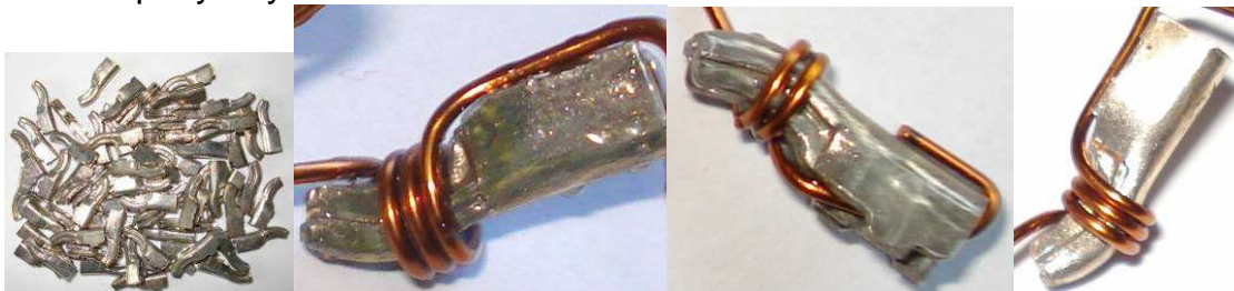
Obr. 6-17 Průběh vzniku koroze na Sn4 ve vlhkostní komoře
