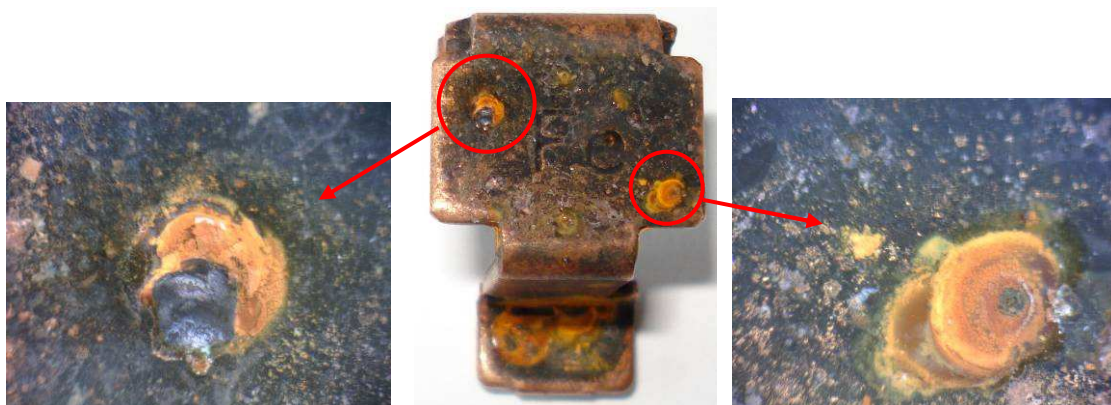
Obr. 6-33 Snímek dílce pas přívodní horní s Cu3 vrstvou po zkoušce korozní odolnosti
