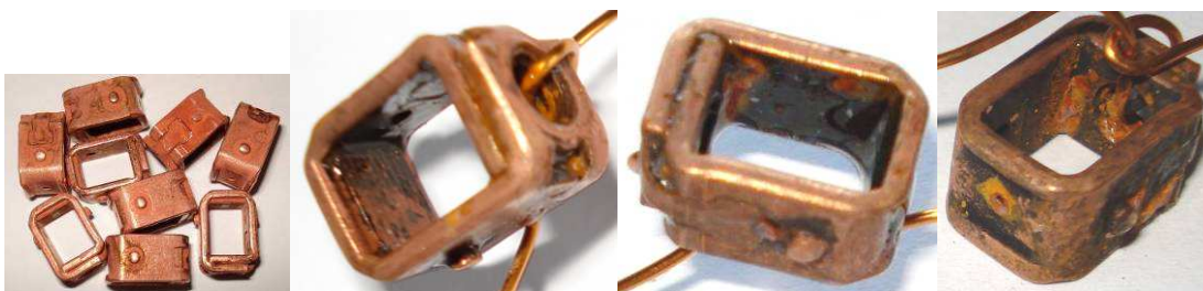
Obr. 6-12 Průběh vzniku koroze na Cu6 ve vlhkostní komoře
