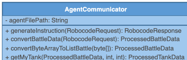
Obr. 3.6: UML diagram třídy AgentCommunicator
