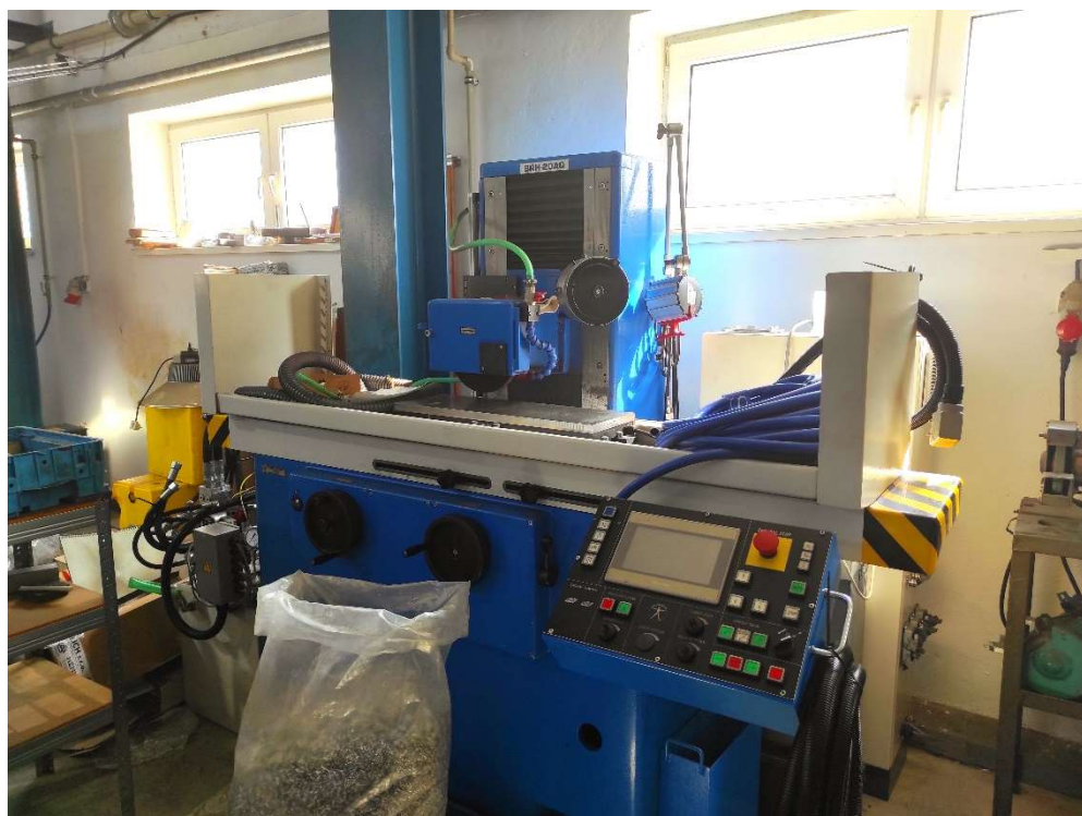
Obr. 13) Vodorovná rovinná brúska BRH 20AQ, vlastné spracovanie
