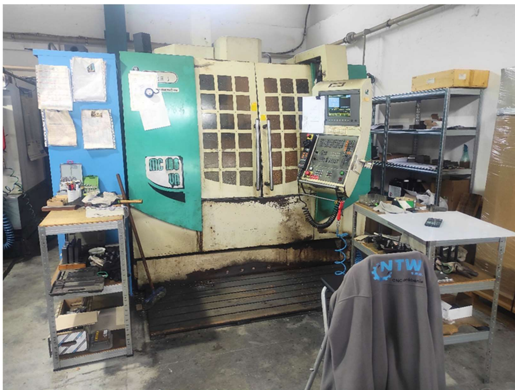
Obr. 10) CNC obrábacie centrum TRENS MC 100VA, vlastné spracovanie
