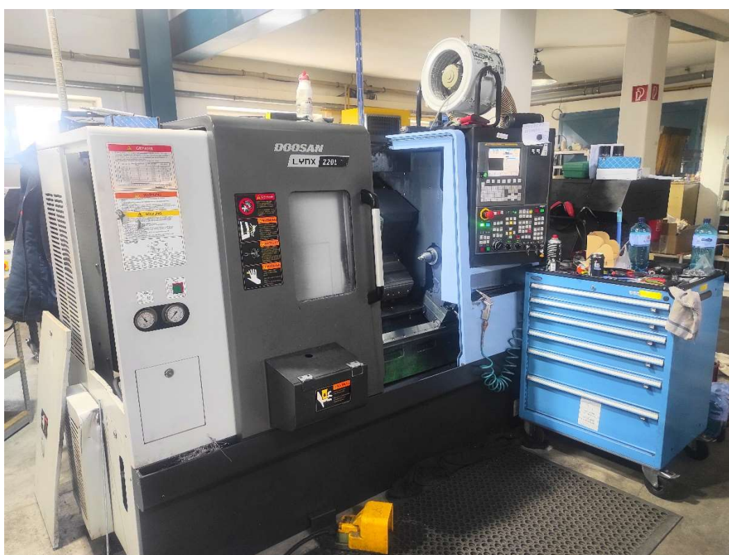
Obr. 12) CNC obrábacie centrum LYNX 220LC, vlastné spracovanie
