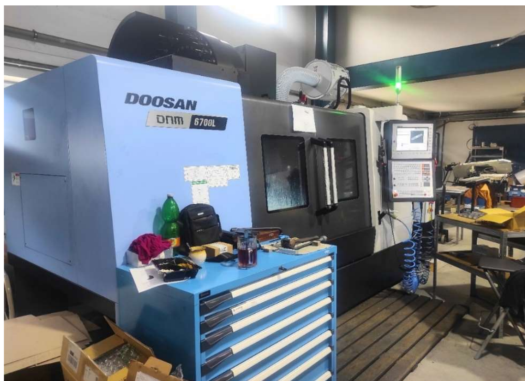
Obr. 14) CNC obrábacie centrum DOOSAN DNM 6700L, vlastné spracovanie
