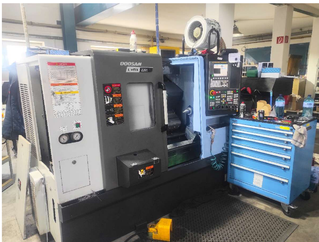
Obr. 12) CNC obrábacie centrum LYNX 220LC, vlastné spracovanie
