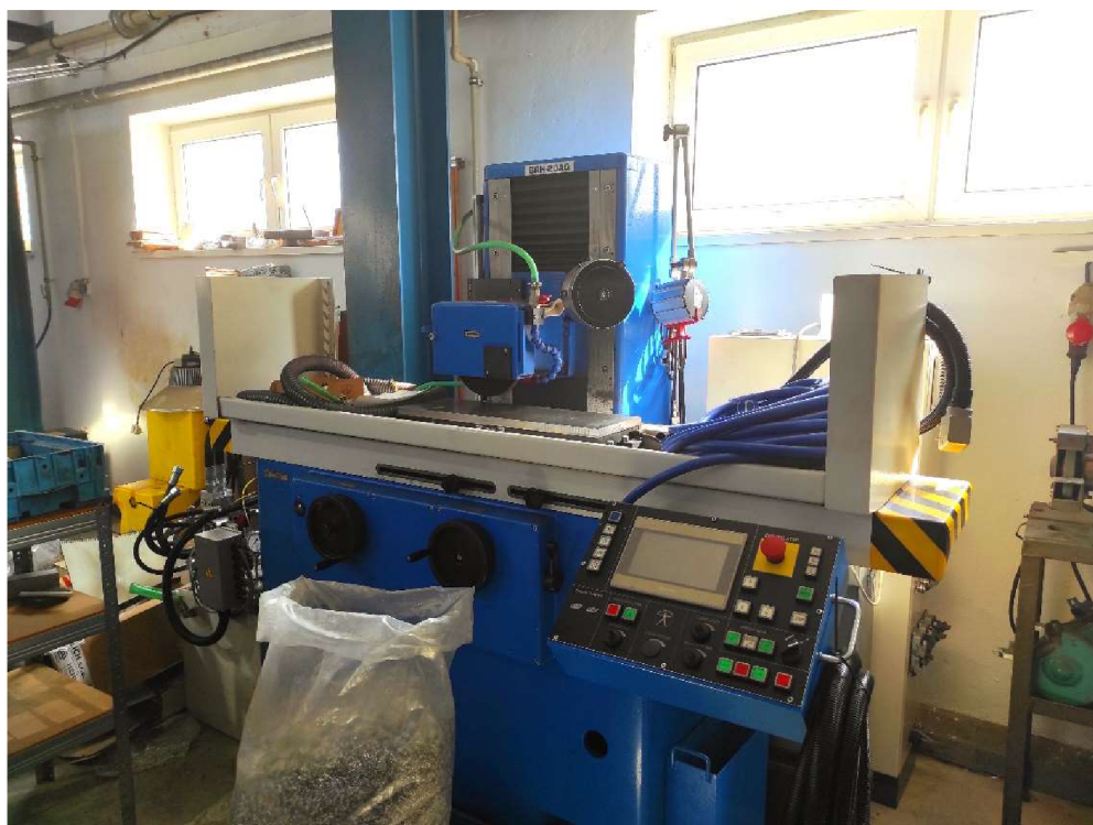
Obr. 13) Vodorovná rovinná brúska BRH 20AQ, vlastné spracovanie
