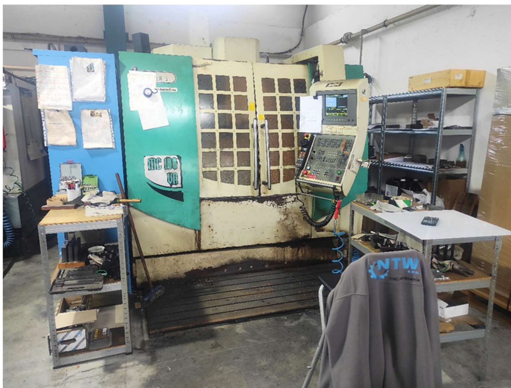
Obr. 10) CNC obrábacie centrum TRENS MC 100VA, vlastné spracovanie
