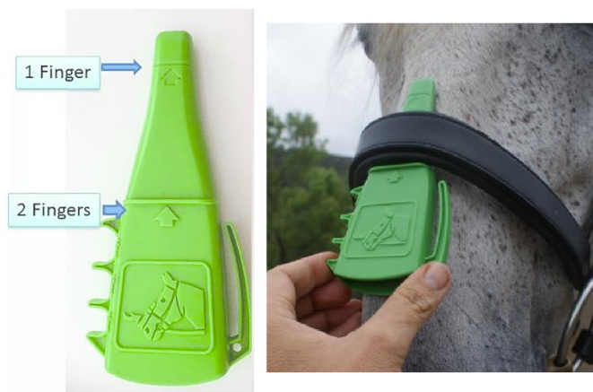
Obrázek 8: ISES Taper Gauger (kuželový měřič utažení nánosníku) (Doherty, 2017)
