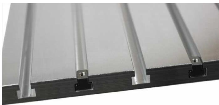
Obr. 9 Upevňovací stôl s T drážkami [13]
