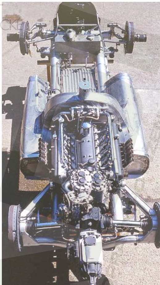
Obr. 40: Celkové uspořádání automobilu Auto-Union 31 [31]
