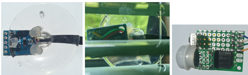
Obr. 6.7: Ukážky senzorov: a) a b) - Senzor úrovne vonkajšieho osvetlenia 65535 upravený pre montáž v okne. c) - Izbový senzor
