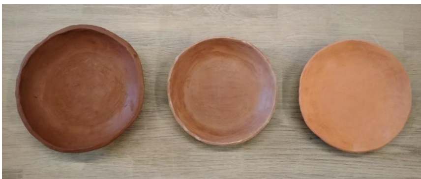
Obrázek 14: Změny v barvě střepe: vymodelovaná miska, vyschlý střepe, střepe po přezahu (vlastní obrázek).
