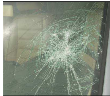
Obr. č. 25 – Příklad porovnání záměrně vytvořeného poškození při zkouškách – sekáč (vlevo) s deklarovaným poškozením po dopravní nehodě (vpravo)
