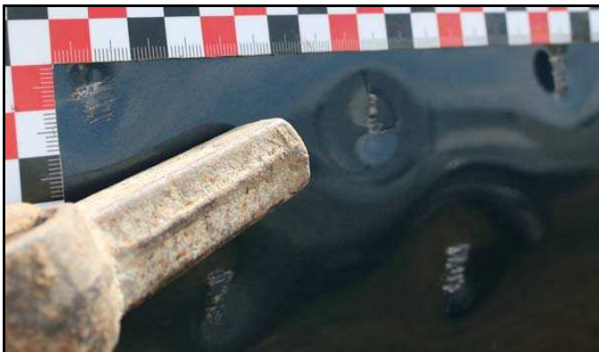
Obr. č. 31 – Příklad porovnání záměrně vytvořeného poškození při zkouškách – tupá strana zednického kladiva (vlevo) s deklarovaným poškozením po dopravní nehodě (vpravo)
