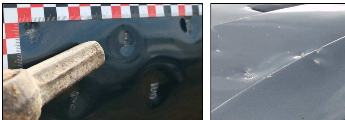
Obr. č. 23 – Příklad porovnání záměrně vytvořeného poškození při zkouškách – tupá strana zednického kladiva (vlevo) s deklarovaným poškozením po dopravní nehodě (vpravo)
