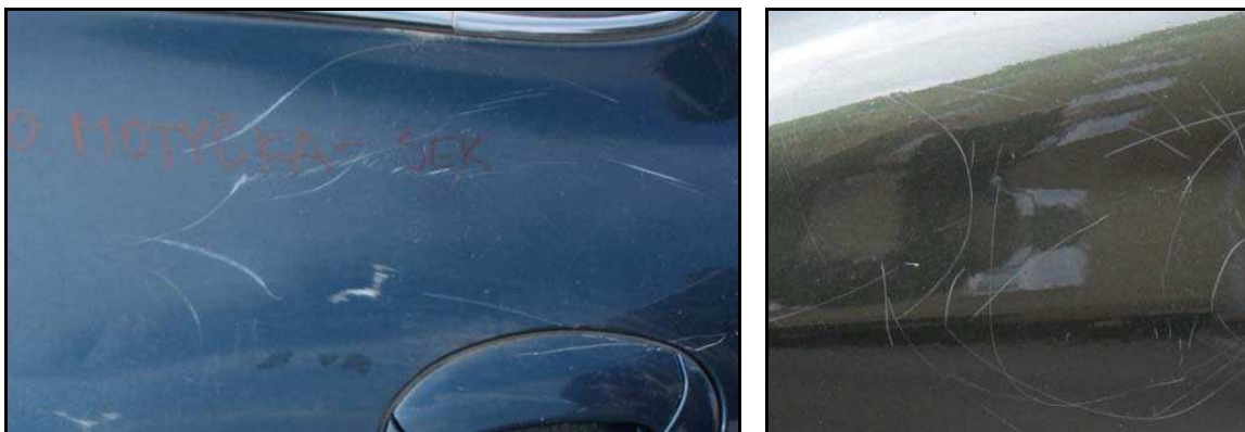
Obr. č. 45 – Příklad porovnání záměrně vytvořeného poškození na zadních dveřích při zkouškách – motyčka (vlevo) s poškozením předního blatníku u parkovaného vozidla (vpravo)
