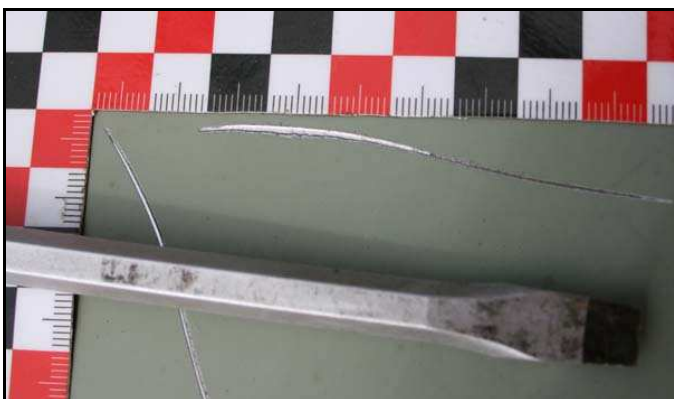
Obr. č. 31 – Příklad porovnání záměrně vytvořeného poškození při zkouškách – tupá strana zednického kladiva (vlevo) s deklarovaným poškozením po dopravní nehodě (vpravo)
