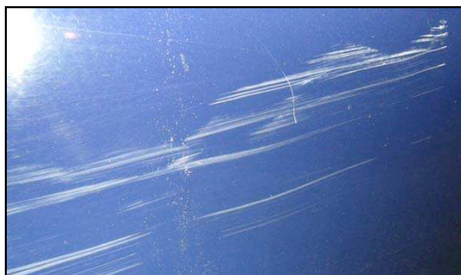
Obr. č. 52 – Příklad porovnání záměrně vytvořeného poškození na nárazníku při zkouškách – cihla (vlevo) s poškozením pravých zadních dveří u parkovaného vozidla (vpravo)
