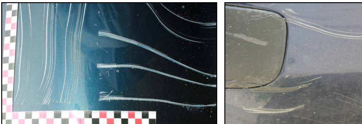
Obr. č. 47 – Příklad porovnání záměrně vytvořeného poškození na levých předních dveřích při zkouškách – železný plát (vlevo) s poškozením pravého zadního rohu u parkovaného vozidla (vpravo)
