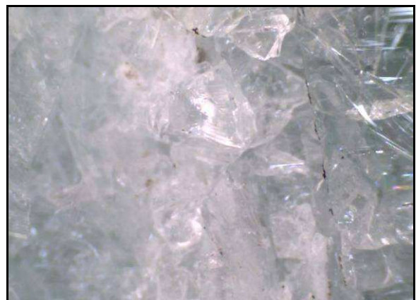
Obr. č. 21 – Vzniklé mechanoskopické stopy (vtisky) způsobené úderem plochého sekáče do čelního skla, kdy po opakovaném úderu vzniká hvězdový typ poškození, zaznamenání detailního záběru z USB mikrokamery
