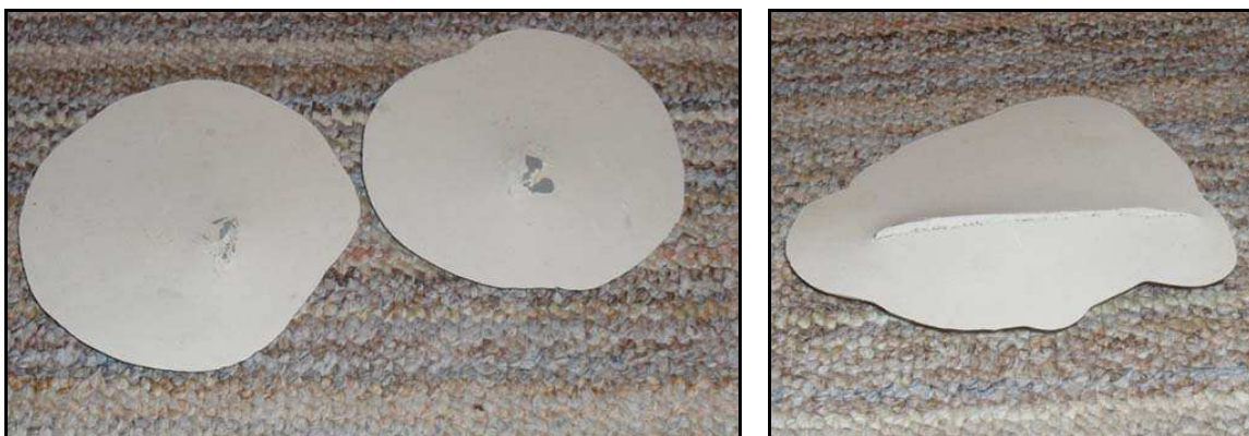
Obr. č. 53 – Zajištění mechanoskopických stop ze střechy z poškození způsobeným silnými údery ocelové trubky (vlevo) a ze zadního víka kufru z poškození způsobeným silným úderem ostrou stranou sekery (vpravo)
