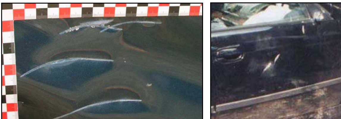
Obr. č. 30 – Příklad porovnání záměrně vytvořeného poškození při zkouškách – ostrá strana zednického kladiva (vlevo) s deklarovaným poškozením po dopravní nehodě (vpravo)
