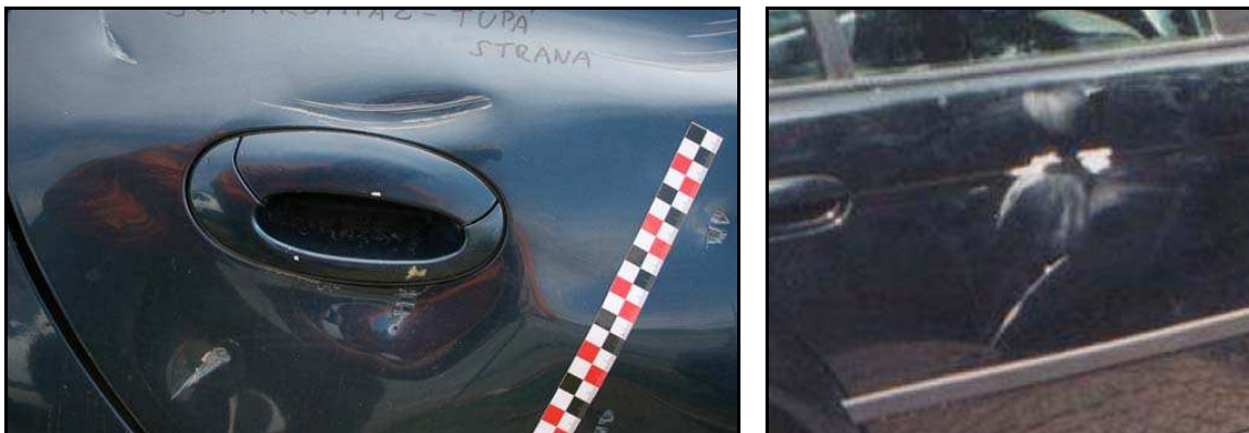
Obr. č. 29 – Příklad porovnání záměrně vytvořeného poškození při zkouškách – tupá strana krumpáče (vlevo) s deklarovaným poškozením po dopravní nehodě (vpravo)
