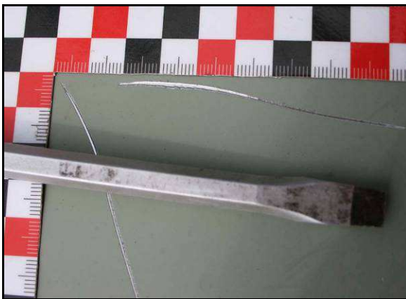
Obr. č. 16 – Vzniklé mechoskopické stopy (rýhy a sešínutí) způsobená tahem šroubováku se zaznamenáním detailního záběru z USB mikrokamery
