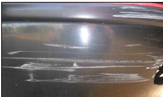
Obr. č. 51 – Příklad porovnání záměrně vytvořeného poškození na nárazníku při zkouškách – cihla (vlevo) s poškozením levého předního rohu u parkovaného vozidla (vpravo)
