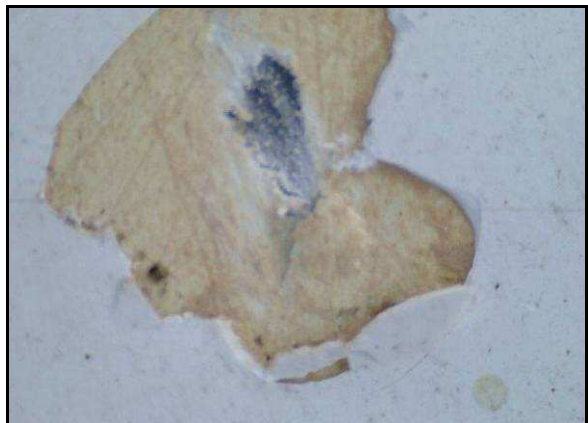
Obr. č. 20 – Vzniklé mechanoskopické stopy (vtisky) způsobené prudkým vržením kamenů do příslušné části karoserie a zaznamenání detailního záběru z USB mikrokamery
