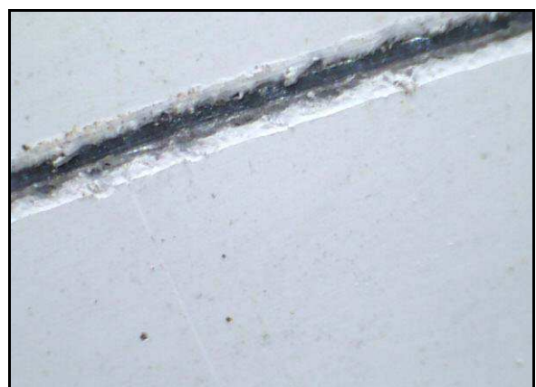
Obr. č. 17 – Vzniklé mechanoskopické stopy (vtisky) po úderu pilníkem a (rýhy) způsobené tahem pilníku se zaznamenáním detailního záběru z USB mikrokamery
