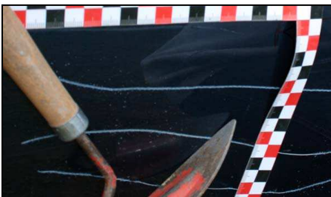
Obr. č. 32 – Příklad porovnání záměrně vytvořeného poškození při zkouškách – šroubovák a ostří motyčky (vlevo) s deklarovaným poškozením po dopravní nehodě (vpravo)
