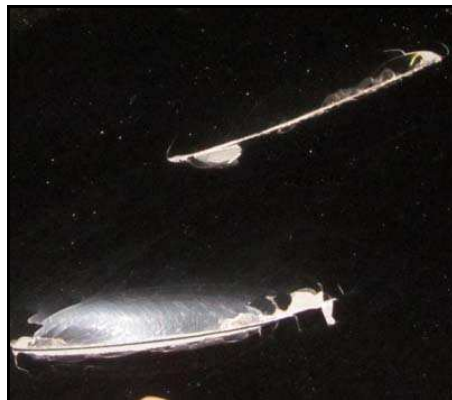
Obr. č. 37 – Příklad porovnání záměrně vytvořeného poškození při zkouškách – sekera (vlevo) s deklarovaným poškozením způsobeném vandalismem (vpravo)
