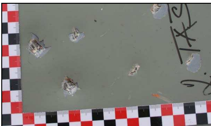
Obr. č. 35 – Příklad porovnání záměrně vytvořeného poškození při zkouškách – údery ostré části krumpáče a rohy střešní krytiny (vlevo) s deklarovaným poškozením po dopravní nehodě (vpravo)
