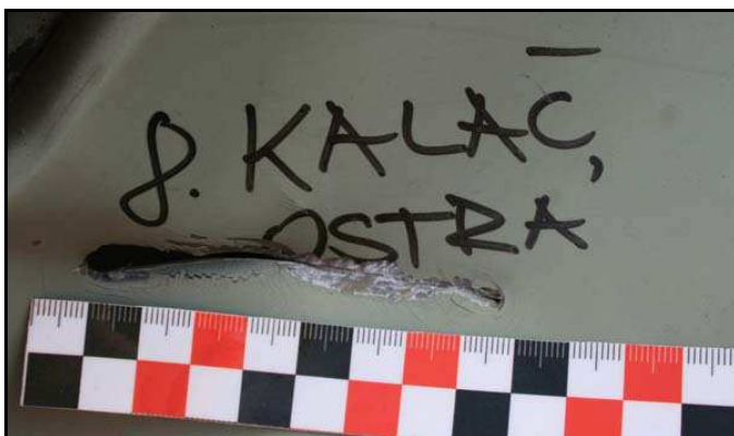
Obr. č. 38 – Příklad porovnání záměrně vytvořeného poškození při zkouškách – kalač (vlevo) s deklarovaným poškozením způsobeném vandalismem (vpravo)
