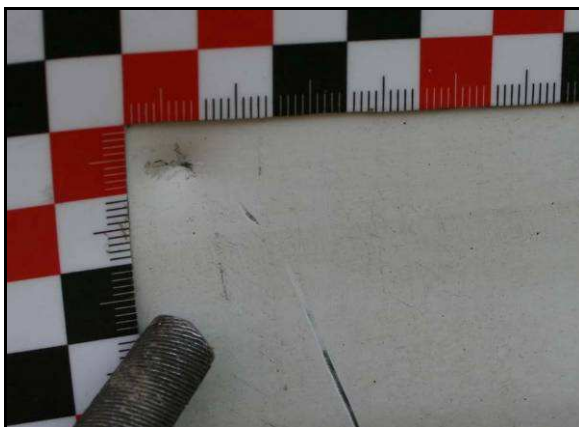
Obr. č. 17 – Vzniklé mechanoskopické stopy (vtisky) po úderu pilníkem a (rýhy) způsobené tahem pilníku se zaznamenáním detailního záběru z USB mikrokamery
