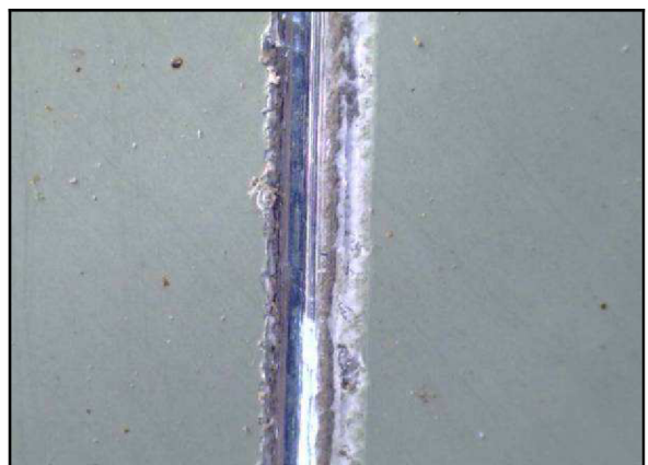
Obr. č. 16 – Vzniklé mechoskopické stopy (rýhy a sešínutí) způsobená tahem šroubováku se zaznamenáním detailního záběru z USB mikrokamery
