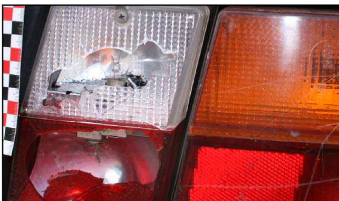
Obr. č. 26 – Příklad porovnání záměrně vytvořeného poškození při zkouškách – pilník plochý (vlevo) s deklarovaným poškozením po dopravní nehodě (vpravo)
