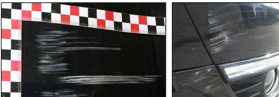
Obr. č. 48 – Příklad porovnání záměrně vytvořeného poškození na levých zadních dveřích při zkouškách – tvárnice (vlevo) s poškozením pravého předního rohu u parkovaného vozidla (vpravo)
