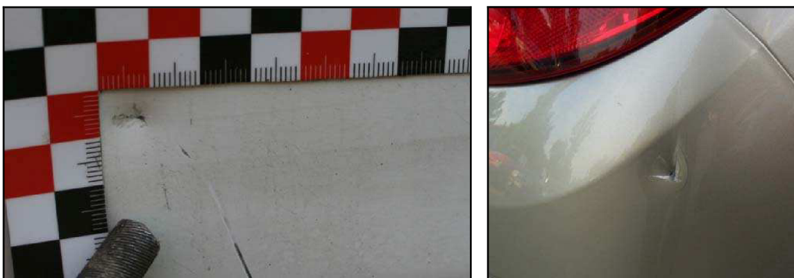
Obr. č. 43 – Příklad porovnání záměrně vytvořeného poškození na zadních dveřích při zkouškách – pilník kulatý (vlevo) s poškozením pravého zadního rohu u parkovaného vozidla (vpravo)
