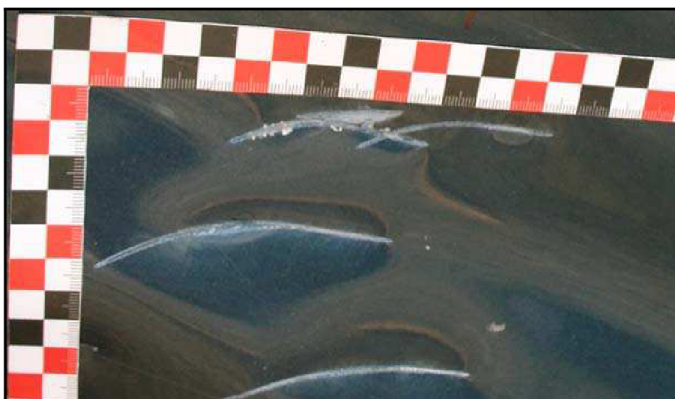
Obr. č. 24 – Příklad porovnání záměrně vytvořeného poškození při zkouškách – ostrá strana zednického kladiva (vlevo) s deklarovaným poškozením po dopravní nehodě (vpravo)
