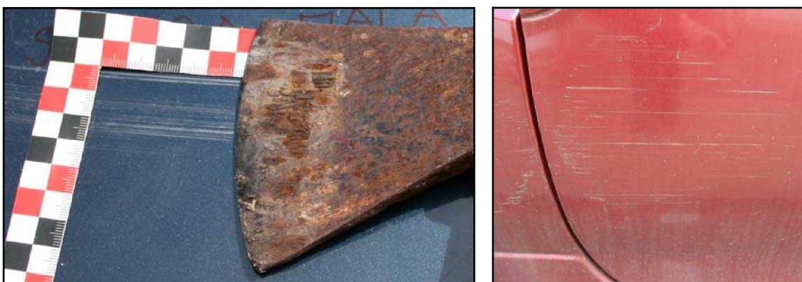
Obr. č. 49 – Příklad porovnání záměrně vytvořeného poškození na kapotě při zkouškách – sekera (vlevo) s poškozením pravých předních dveří u parkovaného vozidla (vpravo)
