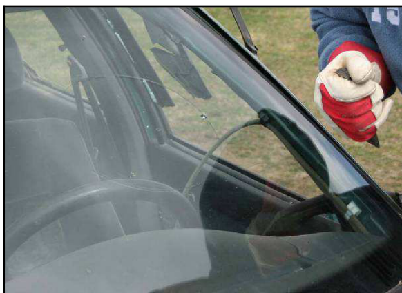
Obr. č. 21 – Vzniklé mechanoskopické stopy (vtisky) způsobené úderem plochého sekáče do čelního skla, kdy po opakovaném úderu vzniká hvězdový typ poškození, zaznamenání detailního záběru z USB mikrokamery
