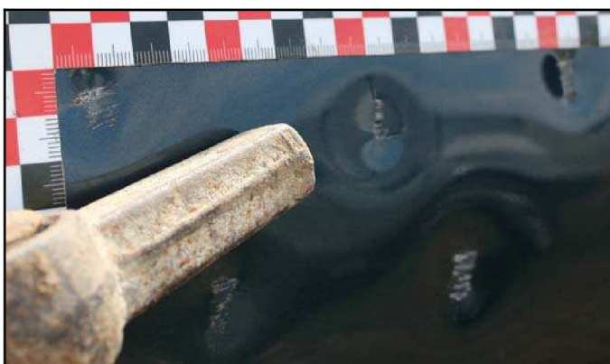
Obr. č. 23 – Příklad porovnání záměrně vytvořeného poškození při zkouškách – tupá strana zednického kladiva (vlevo) s deklarovaným poškozením po dopravní nehodě (vpravo)
