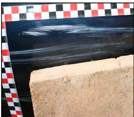
Obr. č. 41 – Příklad porovnání záměrně vytvořeného poškození při zkouškách – cihla (vlevo) s deklarovaným poškozením způsobeném vandalismem (vpravo)
