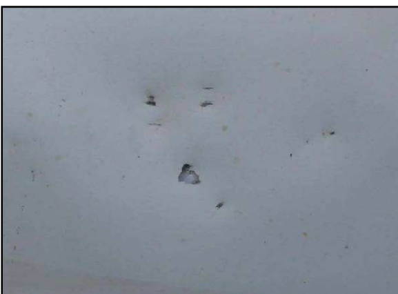
Obr. č. 20 – Vzniklé mechanoskopické stopy (vtisky) způsobené prudkým vržením kamenů do příslušné části karoserie a zaznamenání detailního záběru z USB mikrokamery
