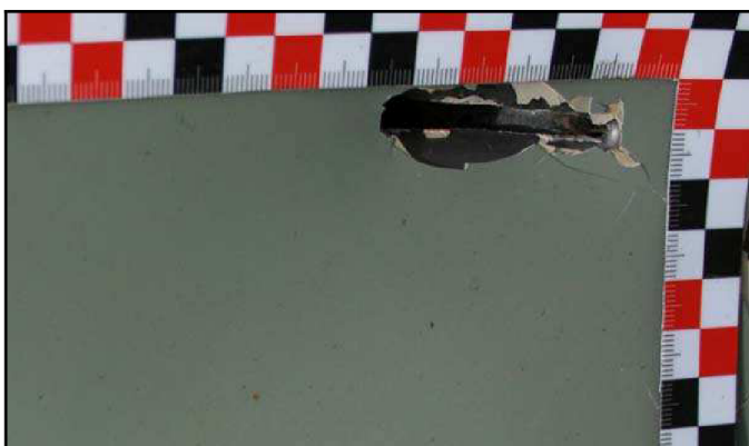
Obr. č. 39 – Příklad porovnání záměrně vytvořeného poškození při zkouškách – krumpáč (vlevo) s deklarovaným poškozením způsobeném vandalismem (vpravo)
