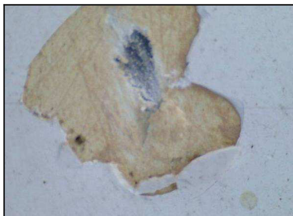
Obr. č. 20 – Vzniklé mechanoskopické stopy (vtisky) způsobené prudkým vržením kamenů do příslušné části karoserie a zaznamenání detailního záběru z USB mikrokamery
