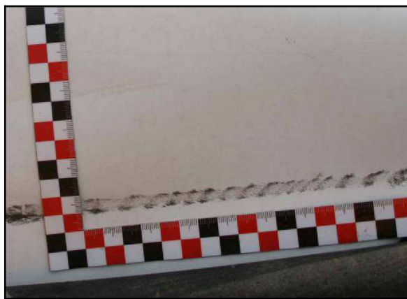
Obr. č. 18 – Vzniklé mechanoskopické stopy (vtisky) po úderu dřevěnou násadou se zaznamenáním detailního záběru z USB mikrokamery
