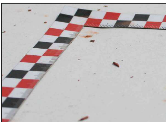
Obr. č. 15 – Vzniklé mechanoskopické stopy (vtisky) způsobené prudkým pádem střešní krytiny se zaznamenáním detailního záběru z USB mikrokamery
