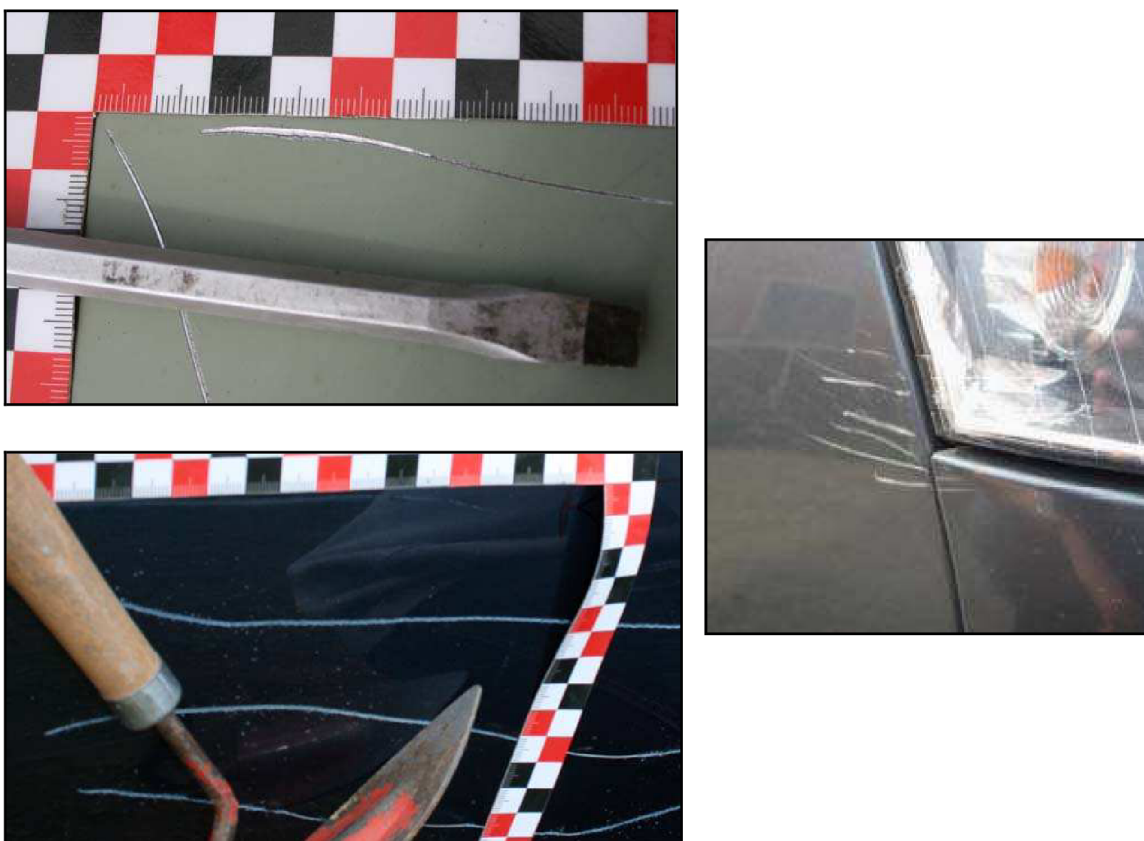
Obr. č. 32 – Příklad porovnání záměrně vytvořeného poškození při zkouškách – šroubovák a ostří motyčky (vlevo) s deklarovaným poškozením po dopravní nehodě (vpravo)
