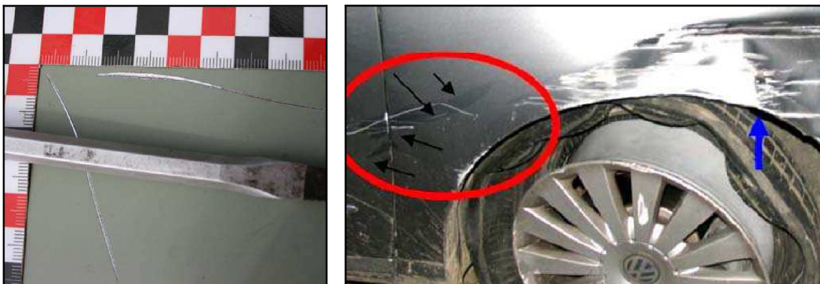
Obr. č. 33 – Příklad porovnání záměrně vytvořeného poškození při zkouškách – šroubovák (vlevo) s deklarovaným poškozením po dopravní nehodě (vpravo)
