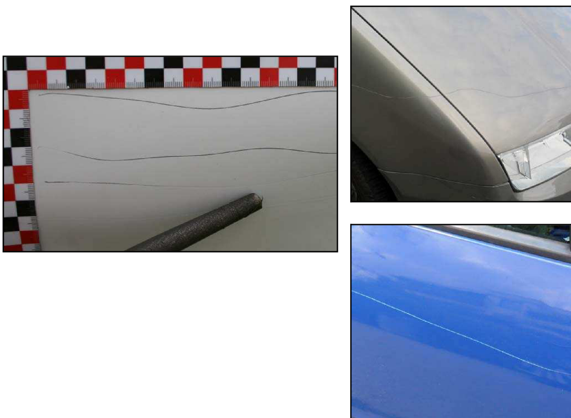
Obr. č. 46 – Příklad porovnání záměrně vytvořeného poškození na předních dveřích při zkouškách – pilník (vlevo) s poškozením kapoty a předního blatníku u parkovaného vozidla (vpravo nahoře) a zadních dveří u parkovaného vozidla (vpravo dole)
