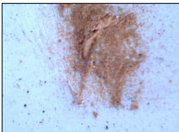
Obr. č. 15 – Vzniklé mechanoskopické stopy (vtisky) způsobené prudkým pádem střešní krytiny se zaznamenáním detailního záběru z USB mikrokamery
