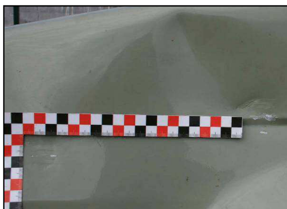
Obr. č. 12 – Vzniklé mechanoskopické stopy (vtisky a sešinutí) po úderu tupou stranou sekery se zaznamenáním detailního záběru z USB mikrokamery
