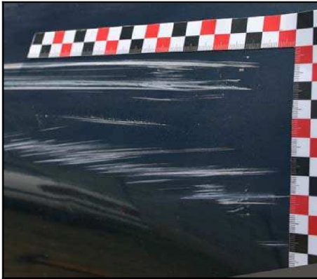
Obr. č. 52 – Příklad porovnání záměrně vytvořeného poškození na nárazníku při zkouškách – cihla (vlevo) s poškozením pravých zadních dveří u parkovaného vozidla (vpravo)
