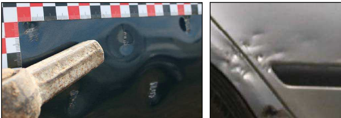
Obr. č. 31 – Příklad porovnání záměrně vytvořeného poškození při zkouškách – tupá strana zednického kladiva (vlevo) s deklarovaným poškozením po dopravní nehodě (vpravo)
