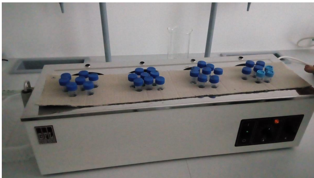
Obr. 17.: Vzorčky umístěné v provizorním držáku ve vodní lázni (foto Radka Čechová)
