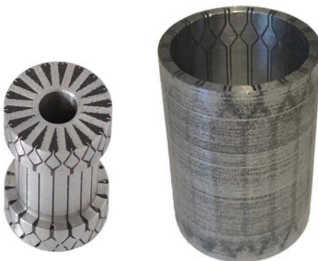
obr. 2-12 Píst a vnější plášť MR tlumiče vyrobený metodou SLM [25]
