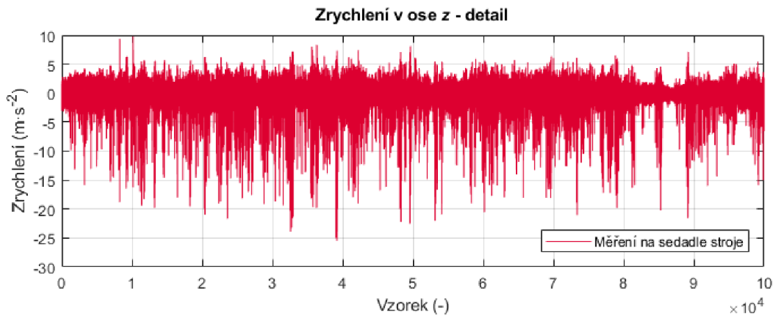
obr. 5-4 Měření zrychlení v ose z na sedadle – špatné nastavení sedadla
