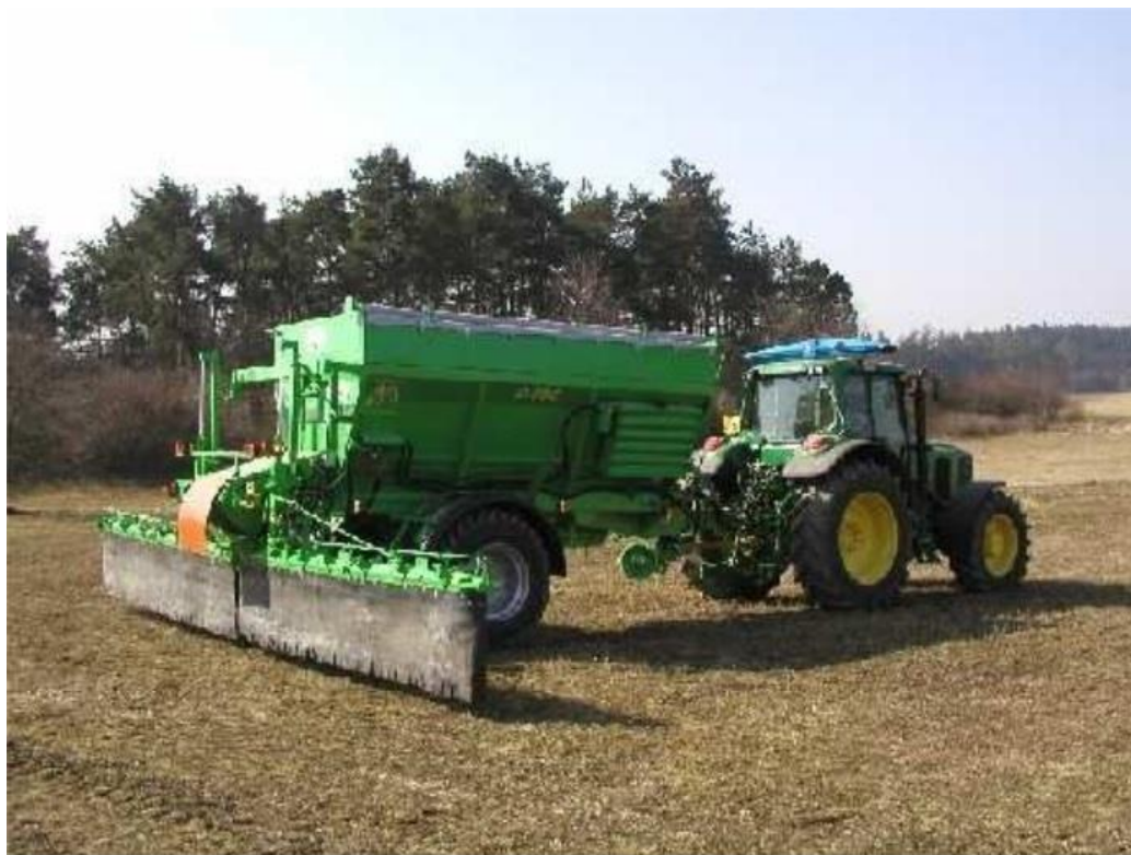
Návěsné šnekové rozmetadlo D-056 Gustrower.
