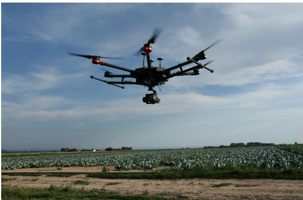
Obrázek 5: Hexakoptéra DJI Matrice 600 osazená termokamerou Wiris využívaná KZS TF ČZU
