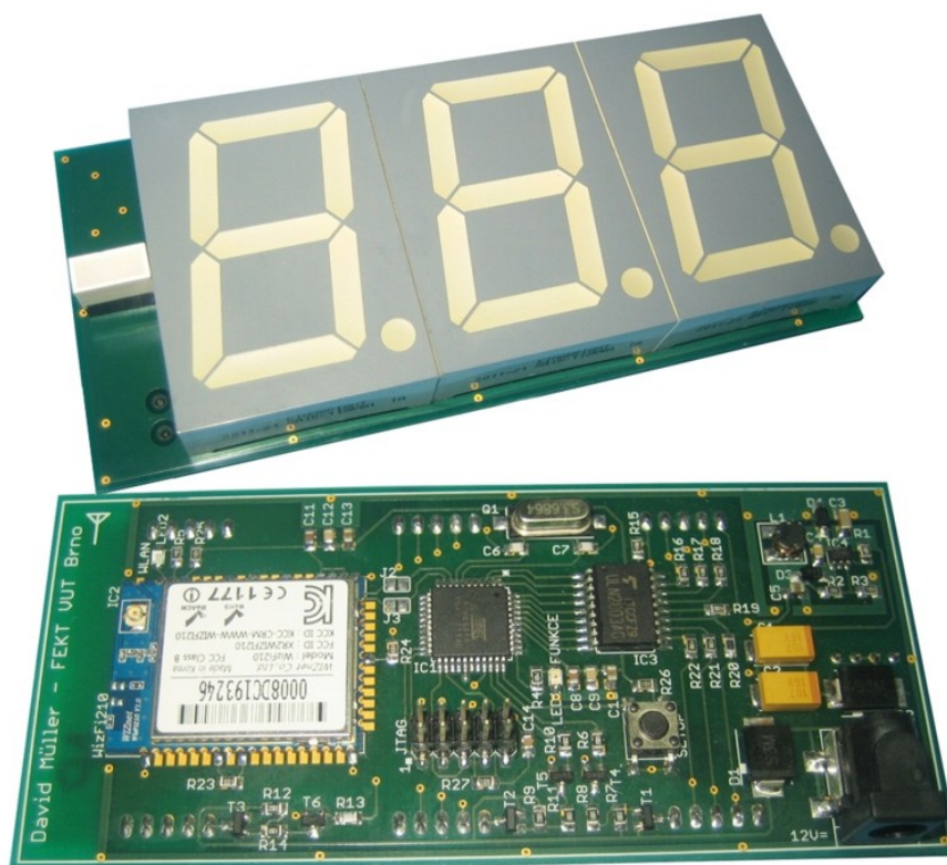
Obr. A.2: Osazená deska jednotky displeje
