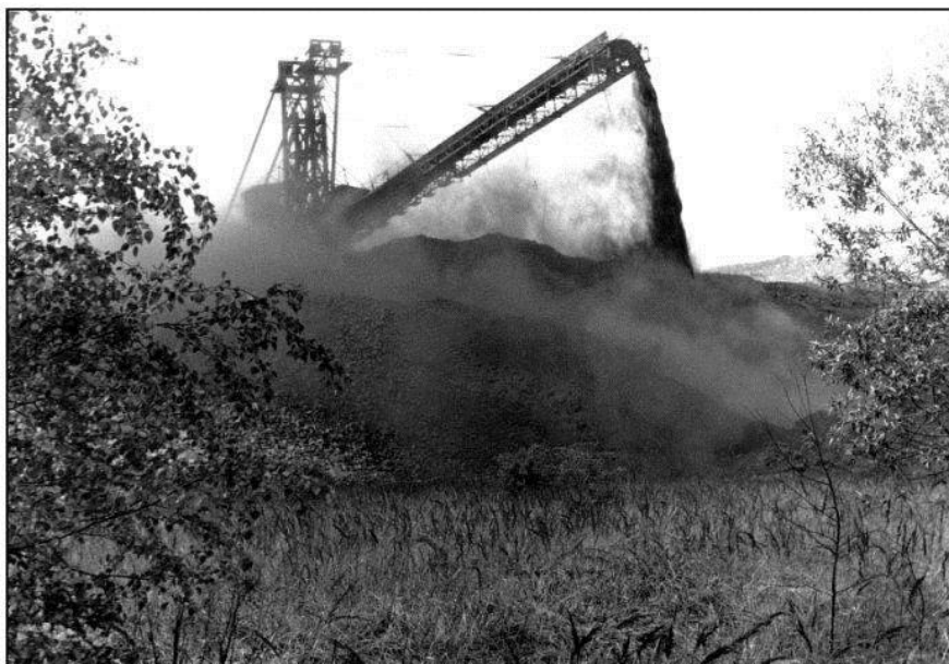
Obr. č. 13, Sypání nadložních zemin pro tvorbu Růžodolské výsypky v letech 1967-1995 (zdroj: mapy.cz)
