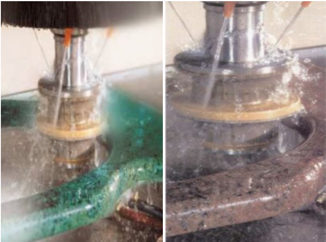
Obr. 2.14 Opracovanie vnútorného otvoru na kuchynskej a kúpeľňovej doske
