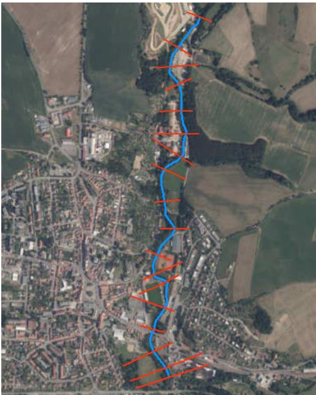
Obr. č. 4-6: Rozmístění příčných profilů
