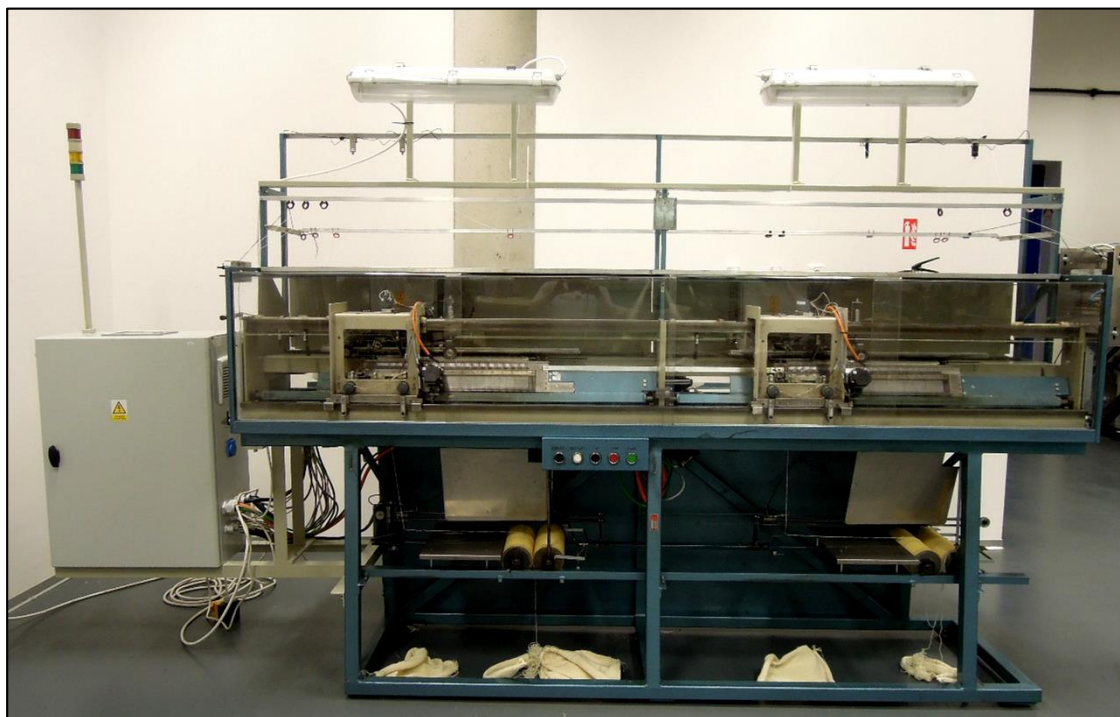
Obr. 1: Pletací stroj po modernizaci (vlevo nová řídicí jednotka)
