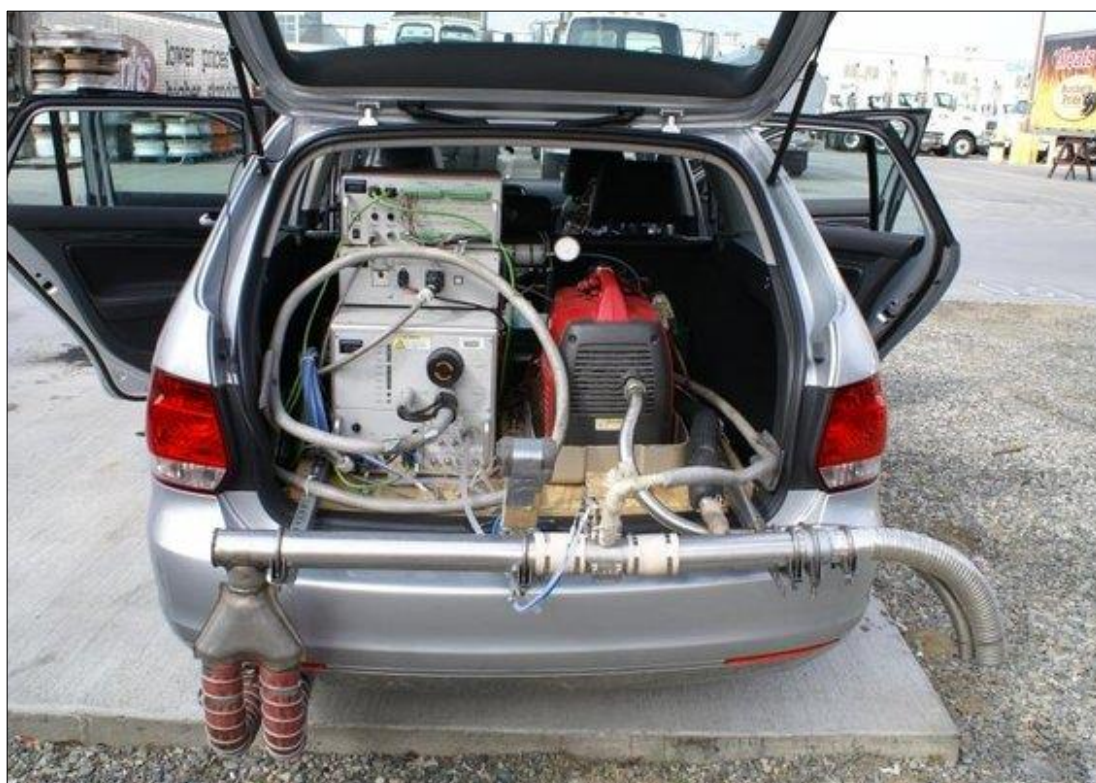
Obrázek 16 - Umístění zařízení PEMS do zavazadlového prostoru (55)
