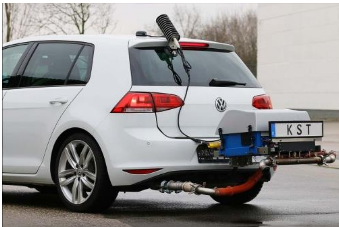
Obrázek 15 - Umístění zařízení PEMS na závěsné zařízení za automobilem (43)
