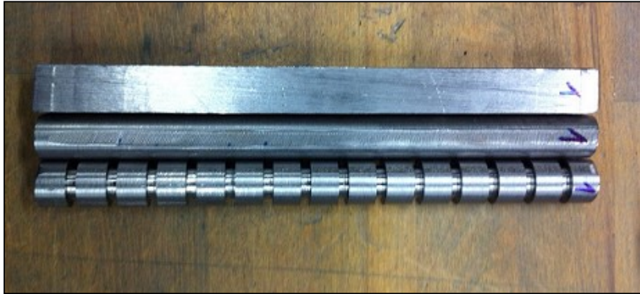
Obrázek 18 Jednotlivé fáze přípravy vzorků
