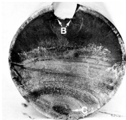
Obr. 2 - Únavový lom hnací hřídele [7] Únavové porušení vzniklo na dně drážky v místech B a postupovalo k závěrečnému lomu v místě C. Materiál: ocel AISI 4320
