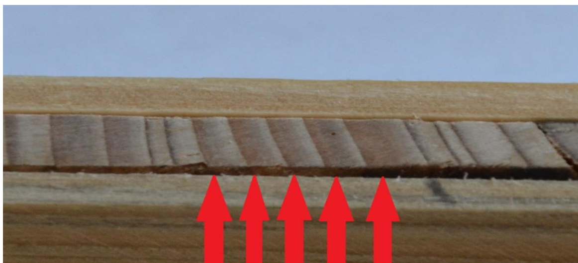
Obr. 18: Fotografie se vzorkem s kontinuální řadou reakčního dřeva, označenou šipkami.
