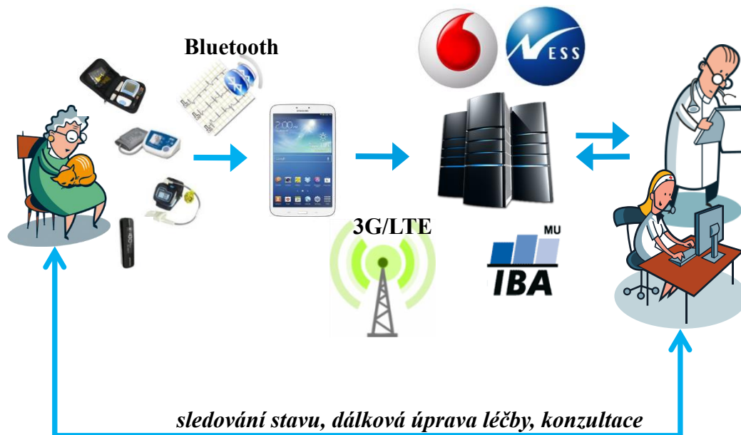
Obrázek č. 25 Schéma moderního telemedicínského systému (interní dokument Národního telemedicínského centra)
