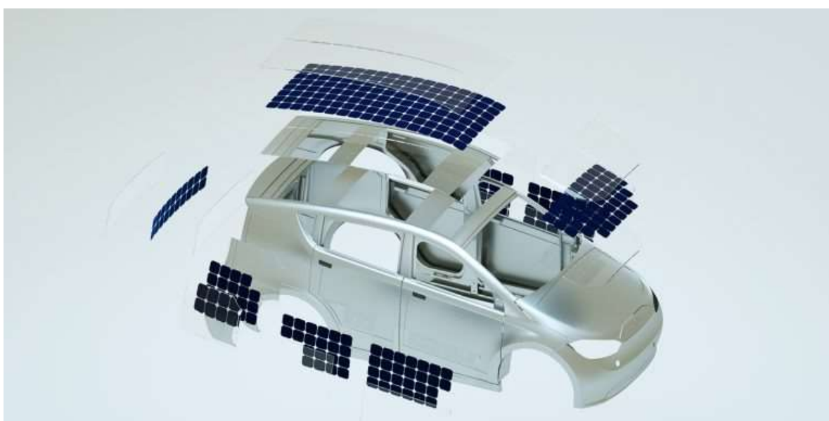
Obrázek 5 Způsob řešení umístění solárních článků u modelu Sion
