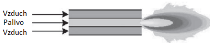
Obr. 13 Zjednodušené schéma difúzního typu hořáku [45]
