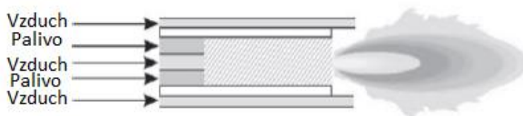
Obr. 14 Zjednodušené schéma hořáku s částečně přemísenou směsí [45]
