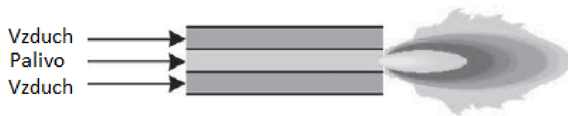
Obr. 13 Zjednodušené schéma difúzního typu hořáku [45]
