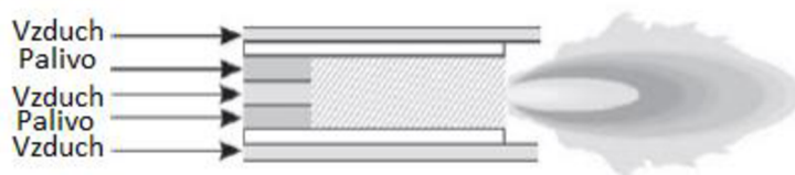
Obr. 14 Zjednodušené schéma hořáku s částečně přemísenou směsí [45]
