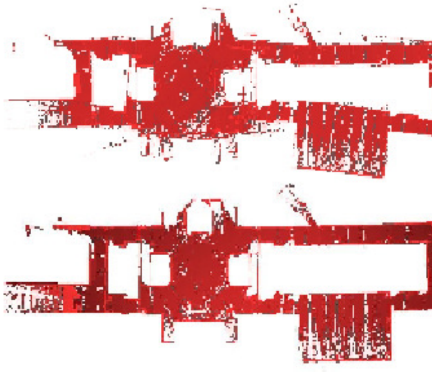
Obrázek 2.7: Nezarovnané a zarovnané scany metodou LUM. Převzato z [2]
