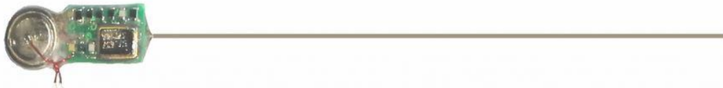
Obr. č. 1: V současnosti nejlehčí komerčně dostupný radiotelemetrický transmitter s označením LB-2X o hmotnosti 0,22 gramu. Výrobce Holohil Systems Ltd.
