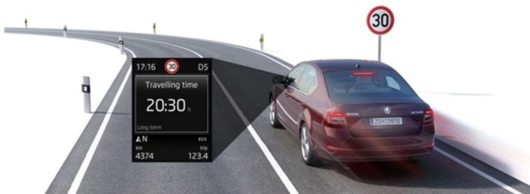
Obrázek 16: Systém rozpoznávání dopravního značení [17]
