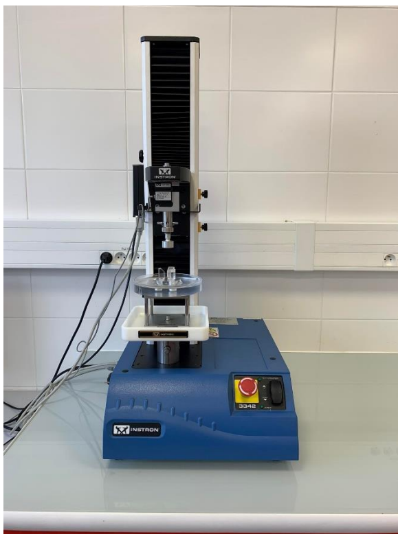
Obrázek 10 Přístroj Instron sloužící k zjišťování pevnosti vaječné skořápky (Autorka BP 2023)
