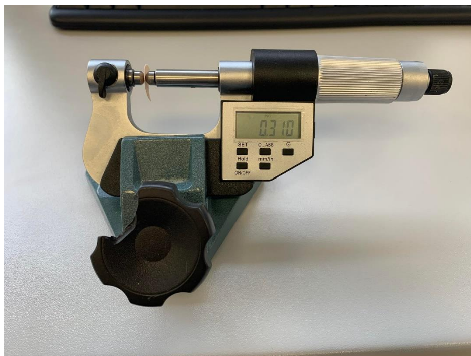
Obrázek 8 Měření tloušťky vaječné skořápky pomocí digitálního mikrometru (Autorka BP 2023)
