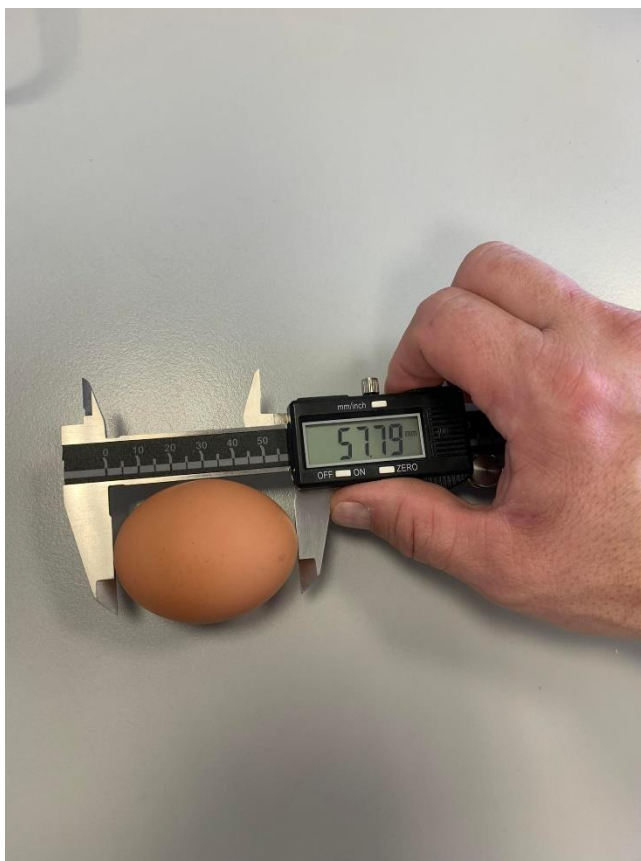
Obrázek 7 Měření délky vejce pomocí posuvného měřítka (Autorka BP 2023)
