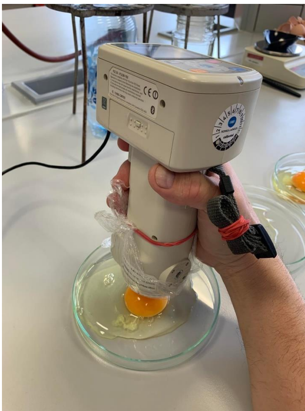
Obrázek 5 Objektivní hodnocení barvy vaječného žloutku pomocí přístroje Minolta (Autorka BP 2023)
