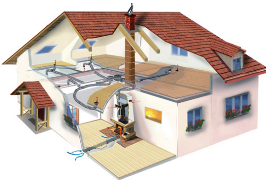
Obr. 1.2 Průřez domu s použitým teplovzdušným rozvodem tepla [16]
