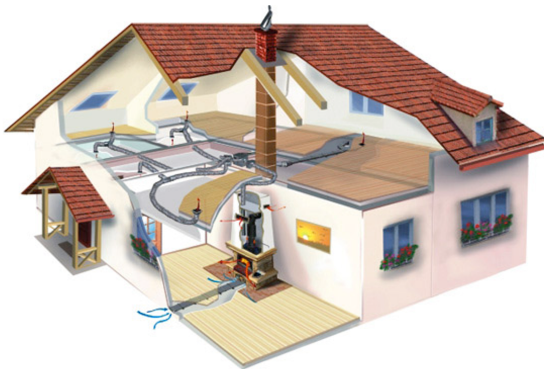
Obr. 1.2 Průřez domu s použitým teplovzdušným rozvodem tepla [16]
