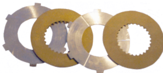
Obr. 5.4 Lamely diferenciálu s viskózní spojkou (převzato z [24]).
