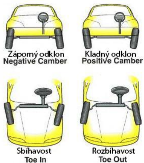
Obr. 5.7: Nastavení geometrie kol ovlivňující jízdní vlastnosti (převzato a upraveno z [28]).
