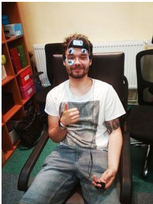
Obrázek 20: Fotografie zobrazující, jak vypadalo umístění snímačů na těle (na fotografii je participant při pilotním měření, který ke zveřejnění fotografie dal svůj souhlas); na prstech levé ruky má participant připojeny elektrody pro měření elektrodermální aktivity a na obličeji elektrody pro měření očních pohybů; participant má nasazené hodinky, které by musel při snímání odložit
