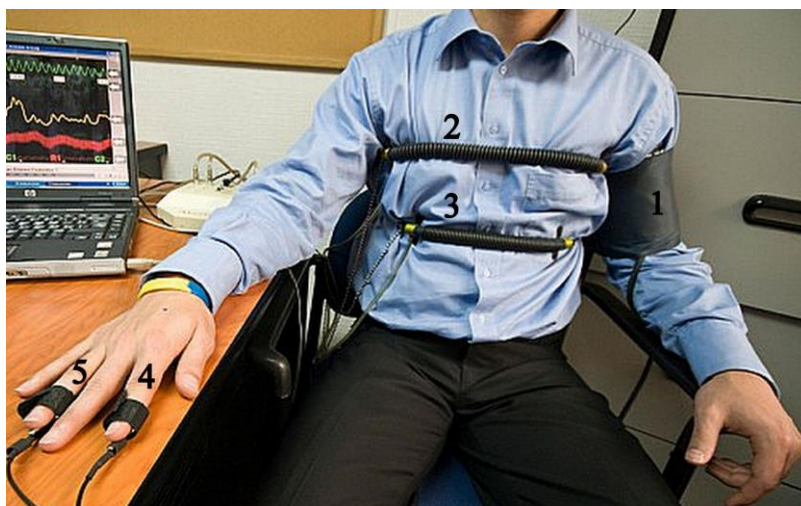
Obrázek 1: Umístění snímačů při polygrafickém testování; číslicí 1 je označena manžeta pro snímání tepové frekvence a krevního tlaku, číslice 2 a 3 označují hadicové pneumografy pro snímání dýchacích mechanismů. Číslicemi 4 a 5 jsou označeny elektrody pro snímání elektrodermální aktivity (získáno 9.7. 2020 z: https://www.dailymail.co.uk/health/article-3424625/Lie-detector-game-helps-reduce-epileptic-fits-Subjects-hooked-polygraph-machine-make-computer-character-just-minds.html a upraveno)
