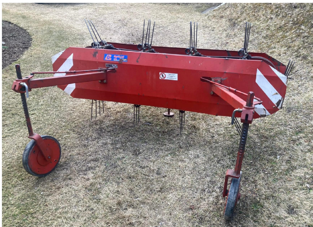
Obrázek 5.1: Obraceč píce – typ SO 160
