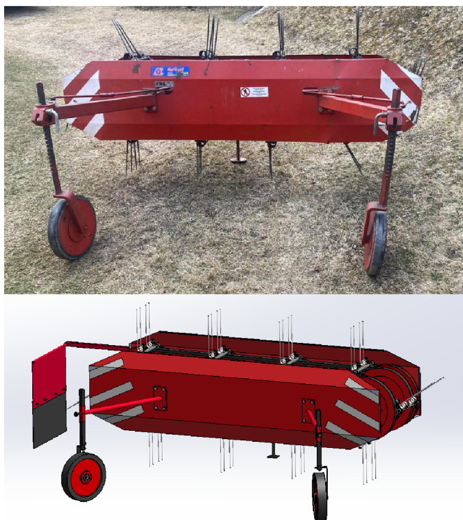
Obrázek 6.1: Porovnání reálného obrabeče a 3D modelu
