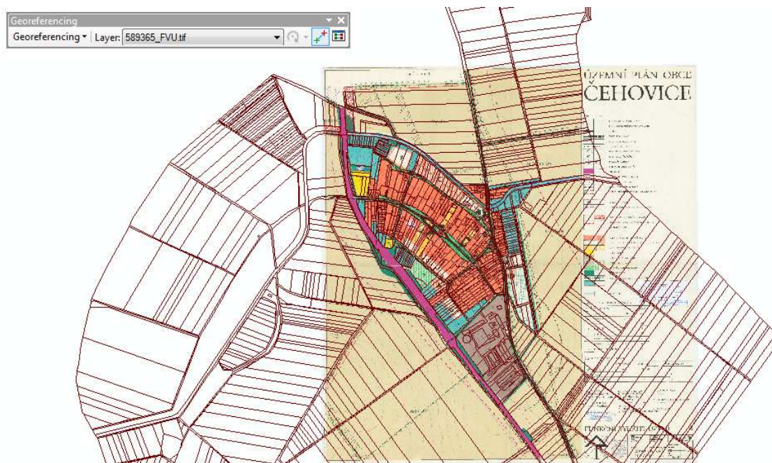
Obr. 24 – příklad georeferencování nad účelovou katastrální mapou v prostředí programu ArcGIS for Desktop, výřez.
