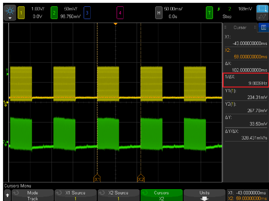
Obr. 6.7: Test signál 2 - časový průběh (žlutá - výstup DAC, zelená - výstup filtru)
