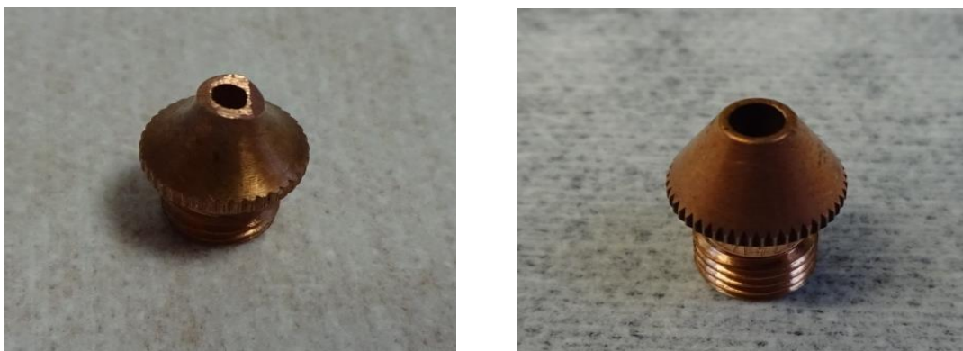
Obr. 17: Opatřebení konvergentní trysky X opotřebení trysky X-Blast Zdroj: Interní zdroj firmy Benteler ČR, s. r. o.
