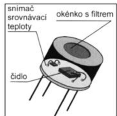
Obr. 3 Uspořádání termoelektrického detektoru [2]
