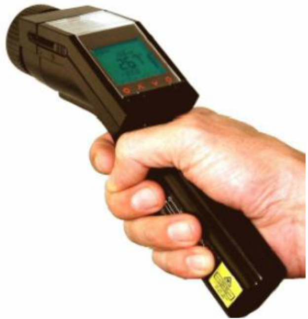
Obr. 9 Ruční IR teploměr DostmannProscan 530 [12]
