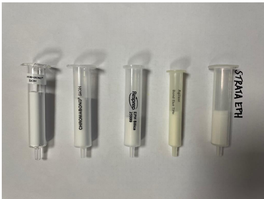
Obrázek 29: Všechny testované komerční kolonky, zleva – skleněná kolonka chromabond, plastová kolonka Chromabond, EPH frakcionační kolonka Restek, plastová kolonka Bond Elut, teflonová kolonka Strata EPH.
