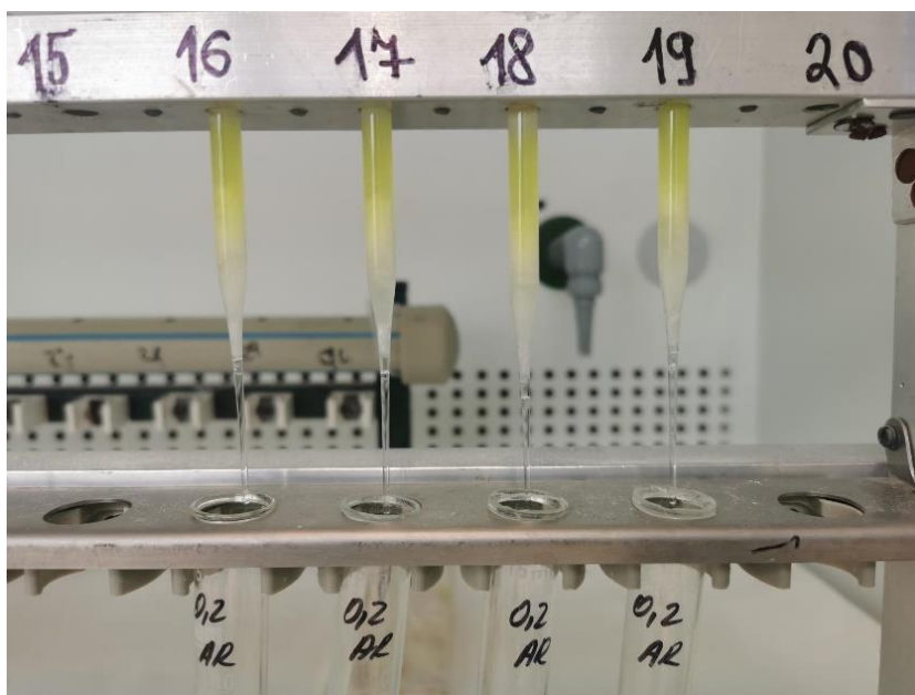
Příloha 2: Roztok mix PAU o koncentraci 0,1 mg/ml nanesený na malé skleněné kolonce, lze pozorovat svítivě žluté zbarvení typické pro PAU.
