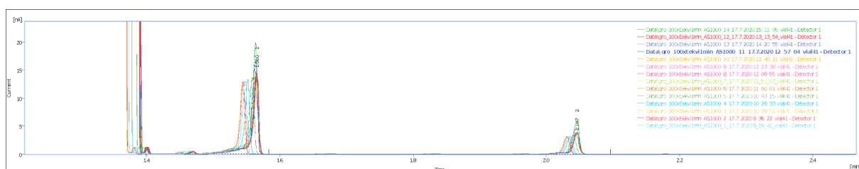
Obrázek 26: Opakovatelnost retence uhlovodíků C6 a C7, teplotní program je uveden v Tabulce 13, měřeno s použitím předkolony; rychlost nástřiku 1000 \mu\text{l}/\text{min} (15 nástřiků).
